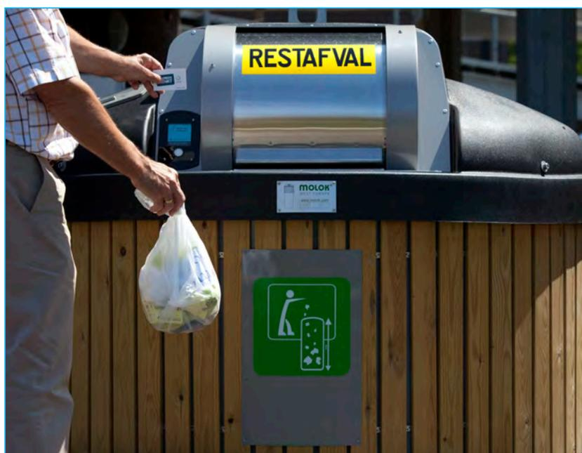
Conteneur équipé d'un tambour et d'un contrôle d'accès pour la redevance au volume
